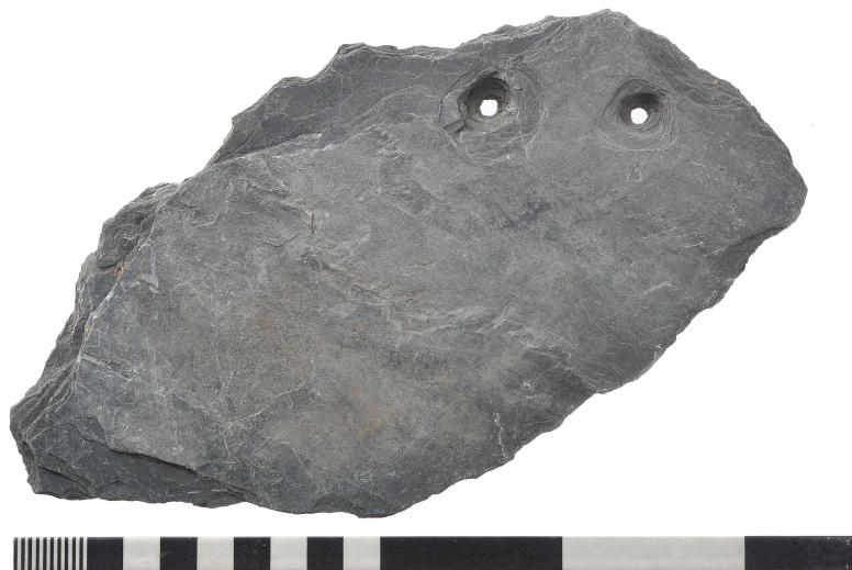
Afbeelding 7.2. Dakpan van leiste met aan één zijde door erosie ontstane kraters rond het montagegat (vnr. 519/4). Foto: L. de Jong.
